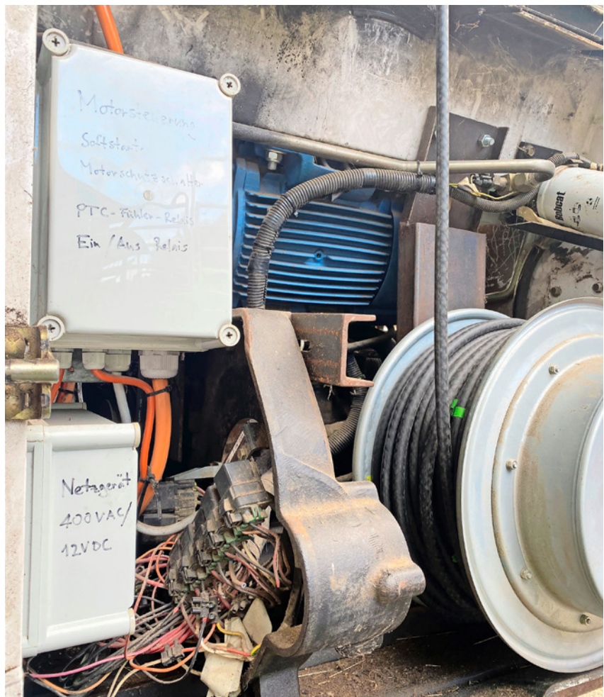
Früher brummte ein alter Dieselmotor, heute surrt ein leiser Elektromotor. Die Kabelrolle fasst 50 Meter Elektrokabel.
