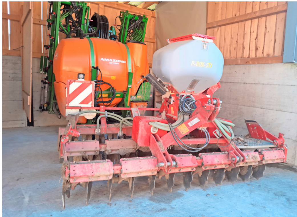
Diese Scheibenegge hat Eric Eichenberger mit einem Aufsatz ergänzt, um als Option im selben Arbeitsgang Gras zu säen.
